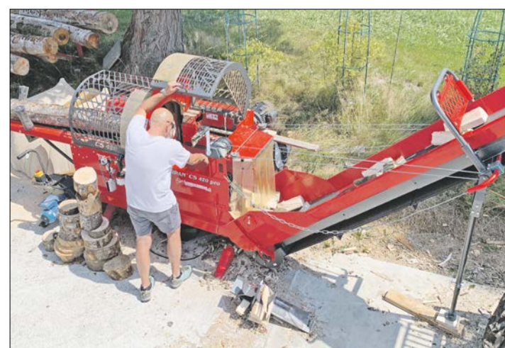
Der Sägespalter im Einsatz: Die Trämel werden automatisch eingeführt, auf 25 cm abgelängt und zu Scheitern gespalten.
