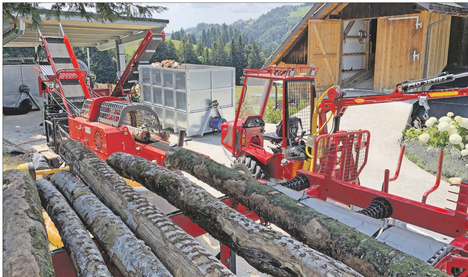
Die Prozesskette zur Brennholzbereitung (v. r.): Rüsttisch, Sägespalter, Förderband, Siebtrommeln zur Reinigung und schliesslich Förderung in die Container. (Bilder Josef Scherer)
